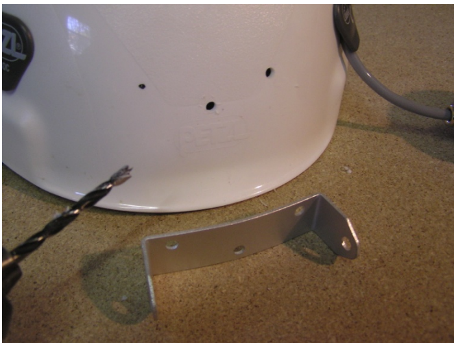
Vorbereitete Bohrungen für den Lampenhalter
