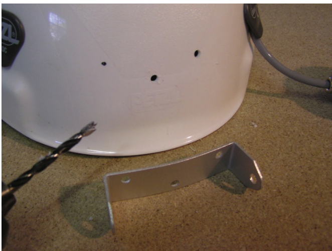
Vorbereitete Bohrungen für den Lampenhalter
