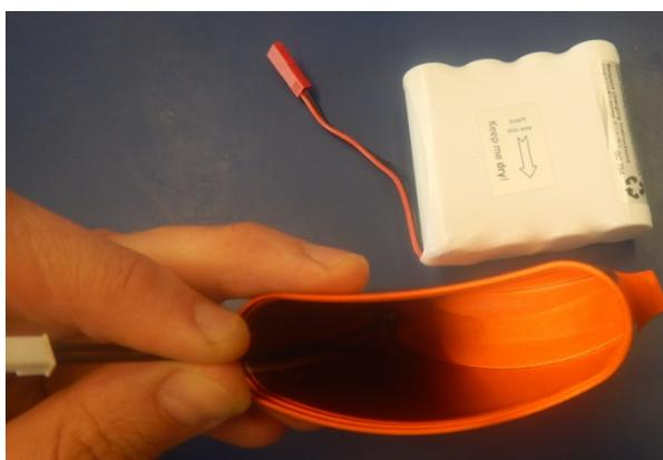
Redresser bien les deux fils noirs contre la paroi du boîtier et enfiler la batterie dans le sens indiqué par la flèche sur le petit autocollant sur la batterie (ça veut dire à l'envers).
