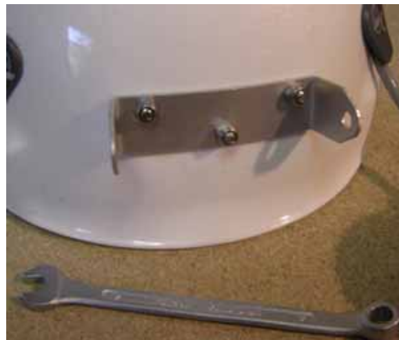
Установленное крепление фонаря
