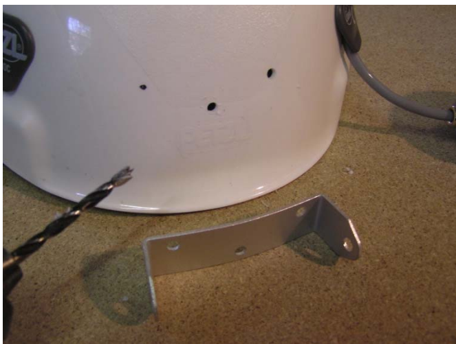
Vorbereitete Bohrungen für den Lampenhalter
