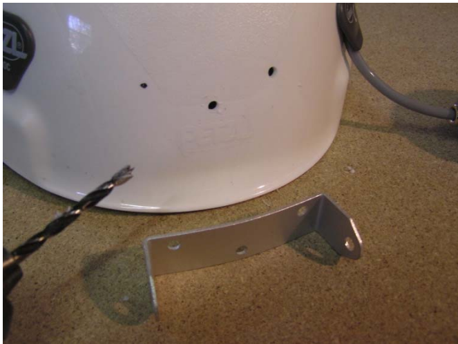
Préparation des trous pour le support de la lampe
